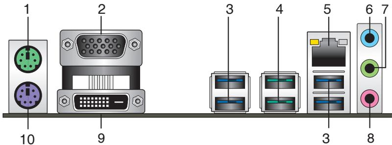
1. **PS/2 Mausanschluss.** Dieser Anschluss ist für eine PS/2 Maus.
