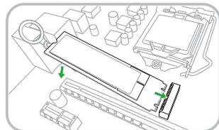
3. Stecken Sie das an der M.2 Befestigungshilfe befindliche Stiften fest in die an selbiger befindliche Öffnung.
